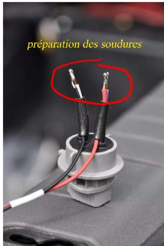
Il est plus facile de préparer les soudures grâce au connecteur ... Attention, le fil de cuivre isolé du faisceau d'origine Toyota s'étame assez difficilement, il faut bien chauffer avec la panne à souder !
