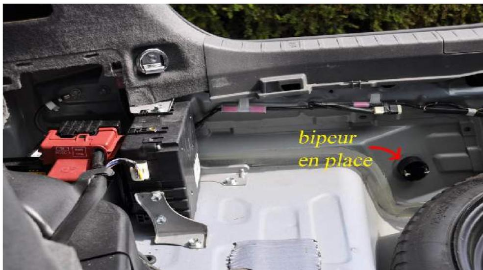
Le bipeur trouve sa place dans le trou libéré par l'opercule en caoutchouc, le diamètre de ce trou est parfait pour le bipeur et l'accès à l'écrou du bipeur est très facile en passant la main derrière le bouclier arrière. Pensez à rajouter un bout de film alimentaire sur la tête du bipeur (à mettre en place avant d'insérer le bipeur dans son trou) afin de le protéger contre l'humidité !
