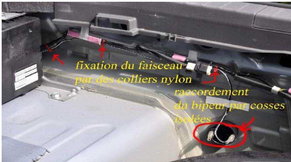
La fixation des câbles au faisceau d'origine évitera les mauvais contacts causés par les vibrations.
