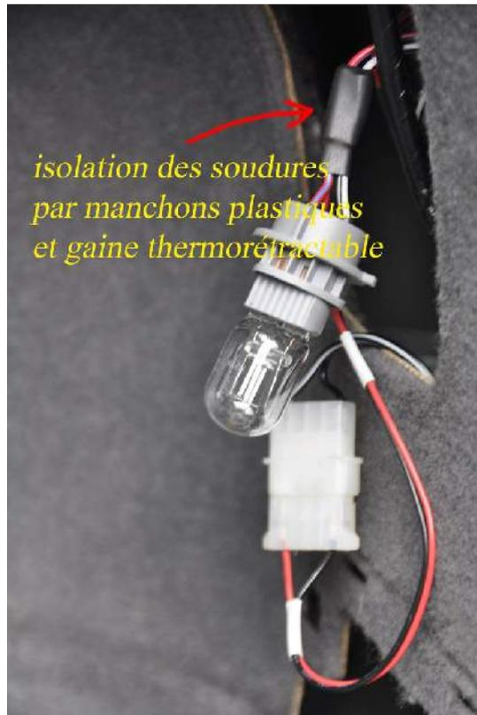
La gaine thermo-rétractable a toujours fait de miracles, mais attention de ne pas trop chauffer au décapeur thermique ou au sèche-cheveux, il n'y a pas beaucoup de place dans ce coin là et les câbles d'origine sont plutôt courts !
