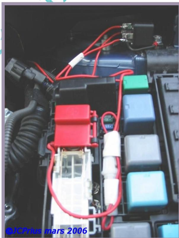
Zoom sur la cosse boulonnée sur la prise +12V (écrou de 6 mm serré sur l'écrou d'origine), avant le placement du porte-fusible 10A dans la boîte à fusibles :
