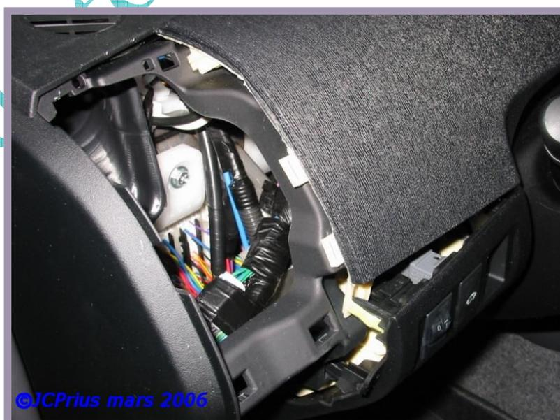
Le cache démonté de l'emplacement pour l'interrupteur :
