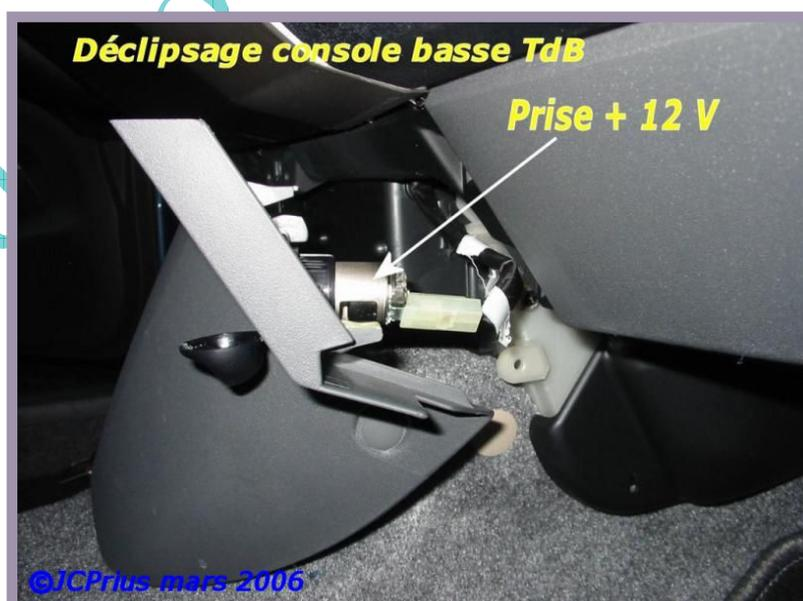
Souder ensuite le fil +12V derrière la prise (c'est ce fil qui ira à l'interrupteur et qui repartira alimenter le bobinage du relais dans le compartiment-moteurs :
