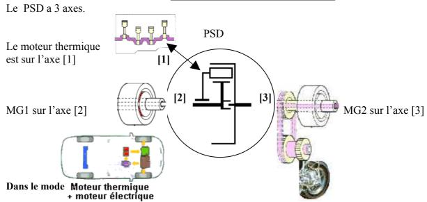
Le thermique entraîne l'axe [1], MG1 sur l'axe [2] fournit l'électricité à MG2 sur l'axe [3]. La totalité de l'énergie motrice du thermique est redirigée vers l'axe [3], les roues.
