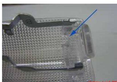
5) Il reste à percer 5 trous en vis-à-vis sur chaque bande métallique.
